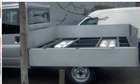
Dank Unterflur-Montierung der Erdgastanks geht kein Platz für die Last verloren (l.), davon profitiert auch der Ford Transit Chassis (r.).
